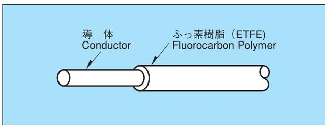
**構造** スズメッキ軟銅線にETFE樹脂を押し出し被覆した電線。
