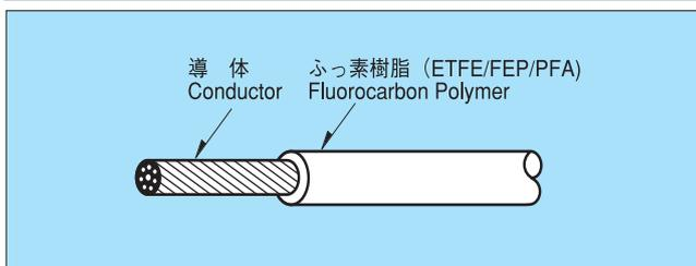
**構造** 特殊な押し出し技術により、極細線に肉厚0.1mm以下のFEP及びPFA樹脂を被覆した電線。
