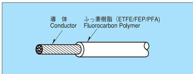
**構造** 可撓構成のスズメッキ軟銅線、裸軟銅線にETFE樹脂を押し出し被覆した電線。
