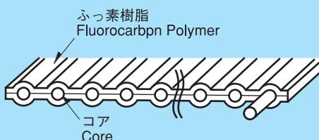
**構造** 多数のふつ素樹脂電線を並列し、絶縁フィルムで上下からラミネートした平型ケーブル。UL規格の認定をうけております。
