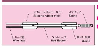
ベルト状ヒータ線とリード線を接続端子で 接続し、その上にシリコーンゴムでモールドし、 完全防水した物。
