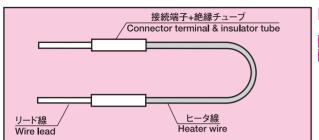
構造 コード状ヒータ線とリード線を接続端子で 接続し、その上に、絶縁チューブを被せた物。 アルミ箔ヒータ加工、巻き付け等が可能。
