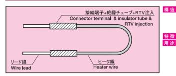
構造 コード状ヒータ線とリード線を接続端子で 接続し、その上に絶縁チューブを被せ、 チューブ内にRTVを注入し、簡易防水し た物。
